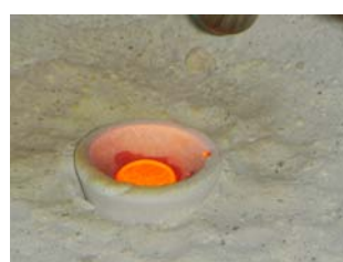
【オレンジ色になる程加熱、ドロドロに溶けあつた中で、鉛だけが皿に吸い込まれていく】
