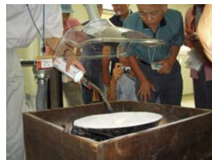
【骨灰皿に見立てた、石灰で出来た皿の上に銀と鉛の合金をセットし加熱】
