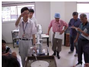
【骨灰皿に見立てた、石灰で出来た皿の上に銀と鉛の合金をセットし加熱】
