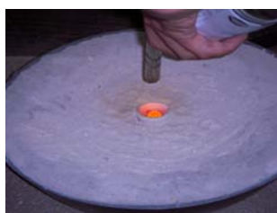
【オレンジ色になる程加熱、ドロドロに溶けあつた中で、鉛だけが皿に吸い込まれていく】
